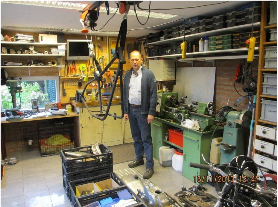
Jan Koolen in zijn schuurtje. Jan gebruikt geen heftafel, maar hangt de motor op aan krollen.
